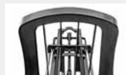
Beim Fahrermodell ist zur Sicherheit ein Fahrerschutzdach angebracht - sollten einmal unerwartet Lasten herabfallen.
